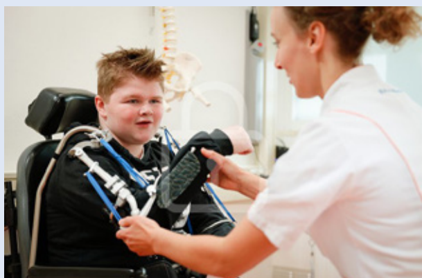
&gt; Figuur 3. Prototype van het passieve arm exoskelet van project A-gear.
