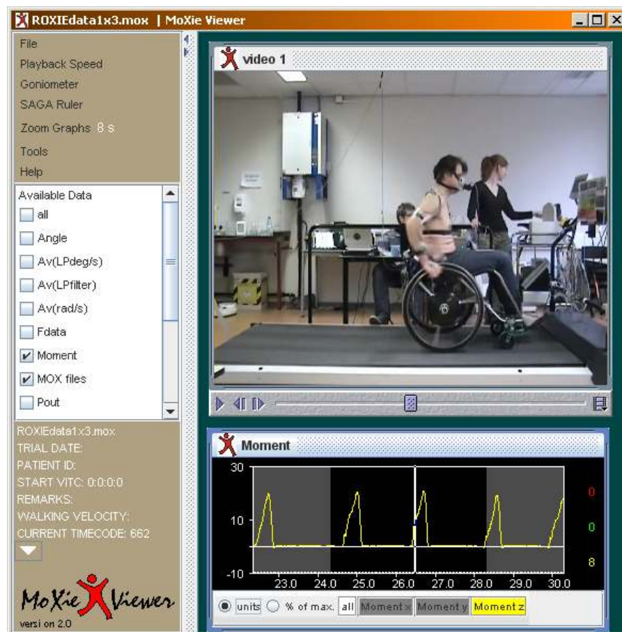
Figuur 5. Aangepaste MoXie Viewer (VUmc) waarmee video van de beweging en krachtleverantie vanuit de meetwielen synchroon kan worden getoond.
