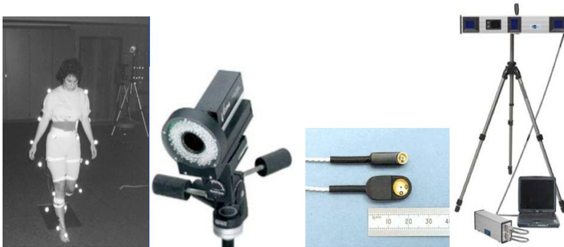
Figuur 5. (Links) passieve reflectieve markers met daarnaast een infrarood camera, (Rechts) actieve infrarood markers met camerasysteem.
