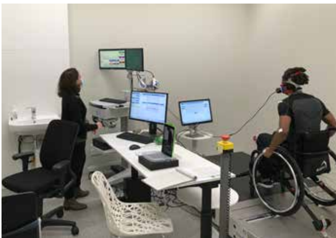
Figuur 4. Twee voorbeelden van evaluatiemethoden ter optimalisatie van de rolstoel-gebruiker-combinatie: a. In het lab kan de Esseda rolstoelergometer betrouwbaar en valide het vermogen en de propulsietechniek van de gebruiker meten, b. In het veld kunnen daarvan afgeleide maten via inertieële sensoren worden gemeten. De combinatie zorgt dat iedere aanpassing objectief kan worden geëvalueerd.
