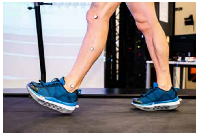
Figuur 1. Gangbeeldanalyse met schoenen met een 3D geprint afwikkelprofiel (fotograaf: Niels Knelis)
