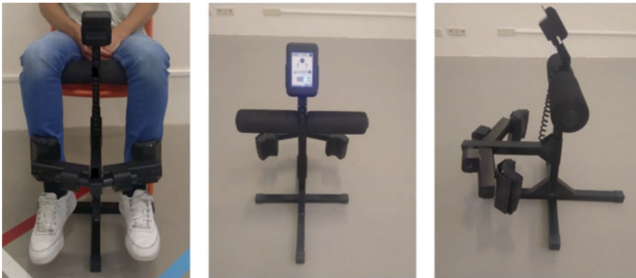
Figuur 3 De Iso-Quad met geïntegreerde krachtsensoren en een scherm waarop de instructies worden gegeven zodat de meting om de juiste manier zelf kan worden uitgevoerd.
