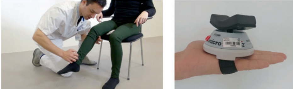
Figuur 1: Handmatige spierkracht test met behulp van een hand held dynamometer (HHD)
