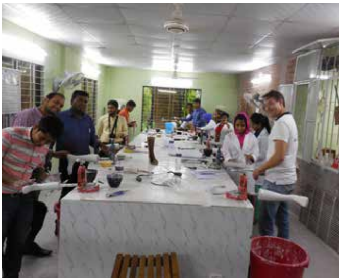
Instrumentmakers corrigeren de gipsmodellen voor enkel-voetorthesen in Bangladesh.
