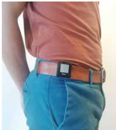
Activiteitenmonitor (accelerometer) die op de broekband werd gedragen om fysieke activiteit te meten.
