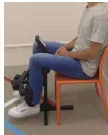
Nieuw ontwikkelde krachtmeter voor het thuismeten van isometrische spierkracht van de knie-extensoren.
