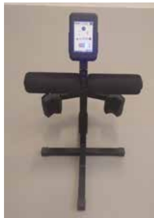
Nieuw ontwikkelde krachtmeter voor het thuismeten van isometrische spierkracht van de knie-extensoren.
