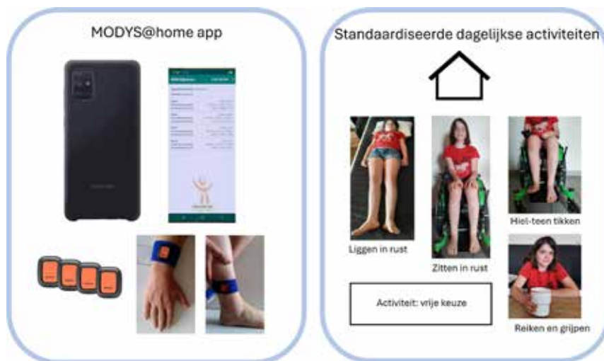
Afbeelding 1. Met de MODYS@home app worden standaardiseerde dagelijkse activiteiten door ouders/verzorgers thuis opgenomen. Hierbij wordt een video van de activiteiten gemaakt en wordt de beweging van de polsen en enkels geregistreerd met bewegingssensoren (IMUs).
